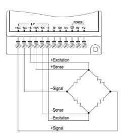
4 wire Loadcell wiring
